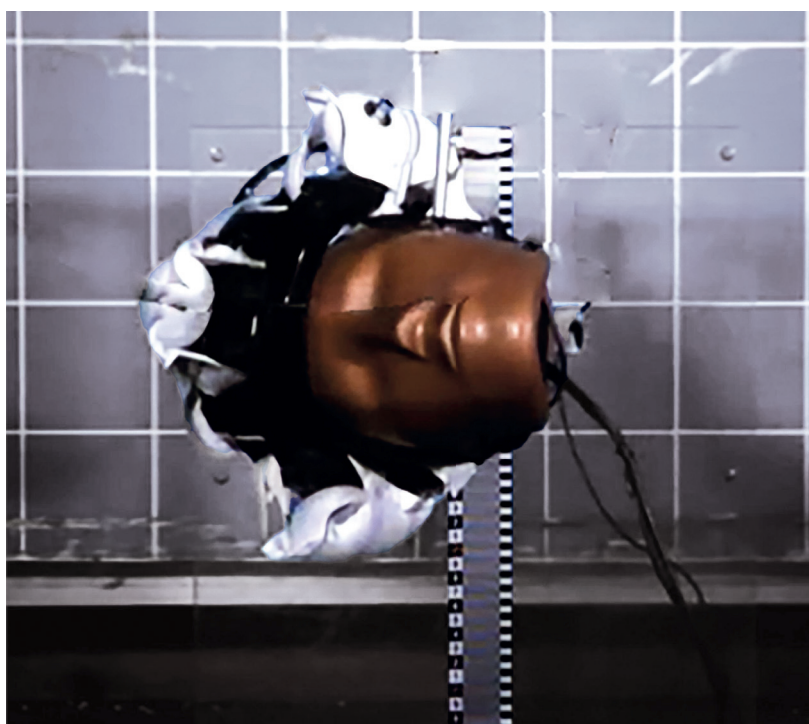
Figura 14: Pruebas del prototipo de sistema de casco de bicicleta Airbag
