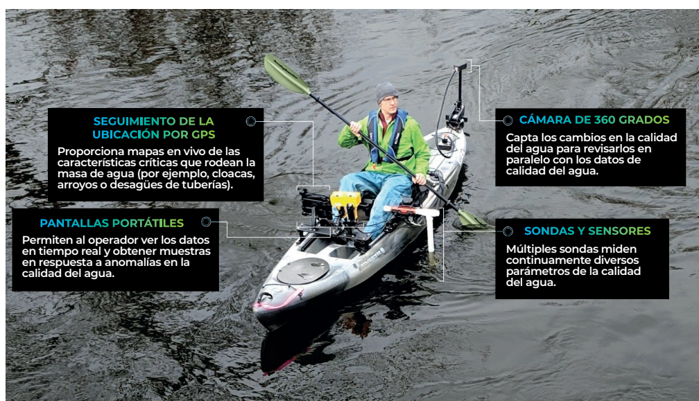
Figura 12: Mapeo en tiempo real de la contaminación del agua
